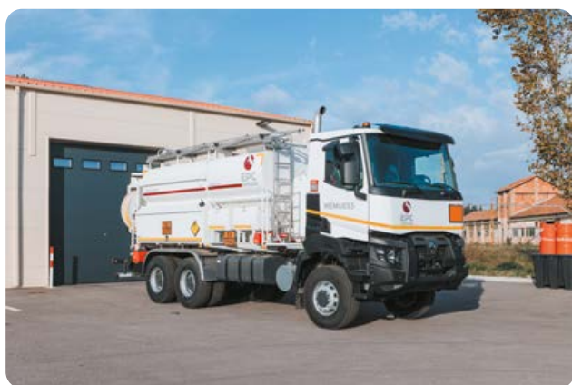
MEMU (Mobile Explosives Manufacturing Unit) ou UMFE (Unité Mobile de Fabrication d'Explosifs)
