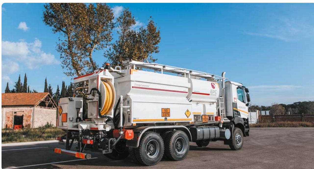
MEMU (Mobile Explosives Manufacturing Unit) ou UMFE (Unité Mobile de Fabrication d'Explosifs)
